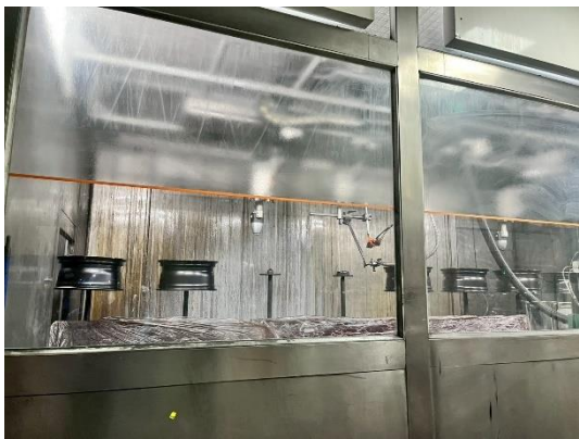
รูปที่ 5 อุปกรณ์บำบัดมลพิษทางอากาศแบบเปียก (Wet Scrubber) ชนิดม่านน้ำ
